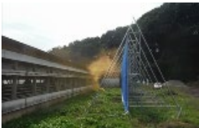
豚舎での遮蔽壁試験(ダストおよび臭気の拡散を抑制できる可能性)
