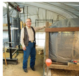
バイオガスが貯蔵された ガスバッグ
