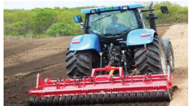
アッパーロータリーによる表層攪拌 (簡易更新)
