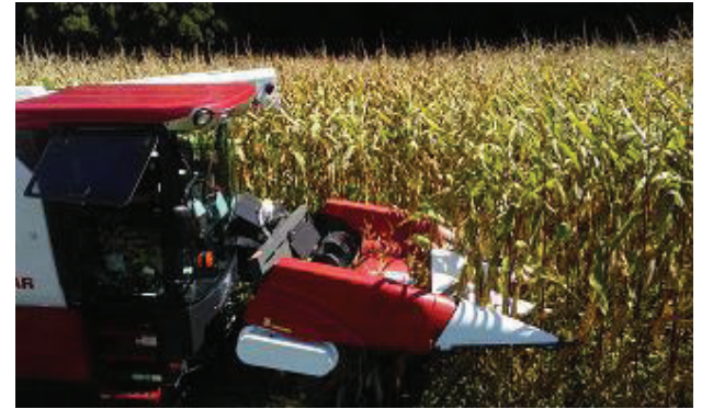
コーンヘッド装着ハーベスタによる収穫
