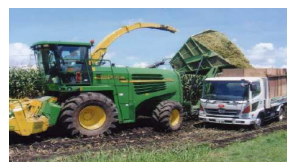
コーンクラッシャー付きの自走式ハーベスタで収穫
