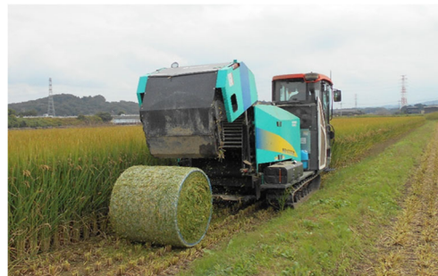
汎用型微細断飼料収穫機
