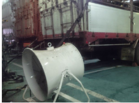
事例2：換気のための扇風機を設置（船内）
