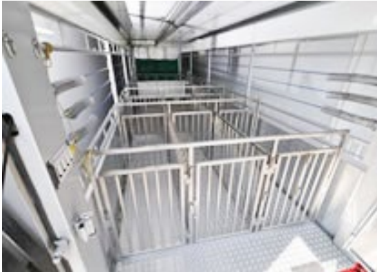
事例3：組立式ケージを使って荷台を区分
