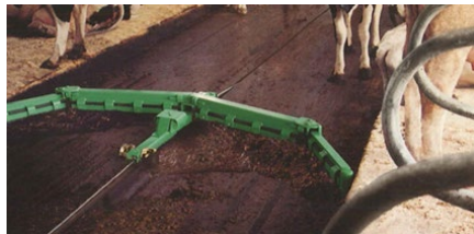
バーンスクレーパーによる適時の除糞
