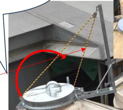
飼料タンク蓋遠隔開閉装置
