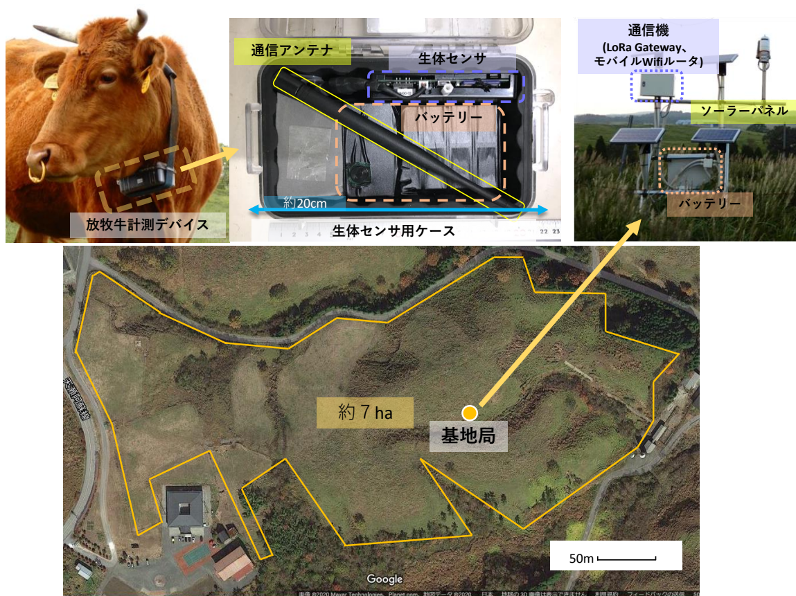
図1. 放牧牛計測デバイスと放牧地内基地局
