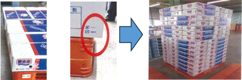
11型パレットに合わせた ダンボールの活用により、 オーバーハング無くパレタイズ
