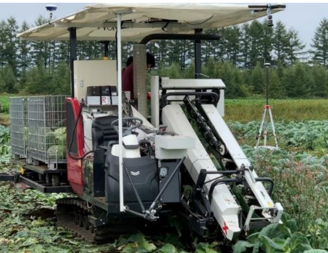
開発中のキャベツの自動収穫機
