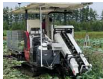
開発中のキャベツの自動収穫機
