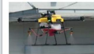
平地では、ドローンのピンポイントでの農薬散布も可能に
