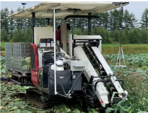
開発中のキャベツの自動収穫機
