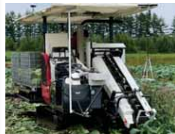
開発中のキャベツの自動収穫機
