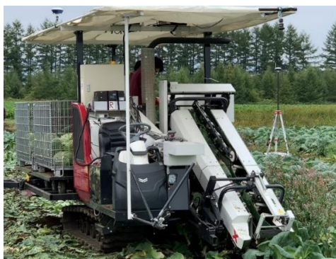
開発中のキャベツの自動収穫機
