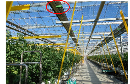
トマト栽培施設での振動発生装置を用いた害虫防除（丸印部分） 資料：東北特殊鋼株式会社
