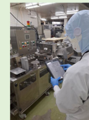
製造工程における電子帳票管理
