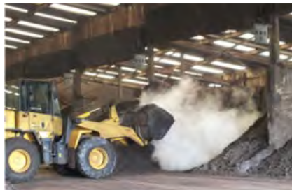
下水汚泥を高温発酵し肥料化(佐賀県) 資料：佐賀市下水浄化センター
