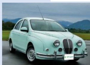
内外装材(ボンネット等)に改質リグニンを導入した試作車
