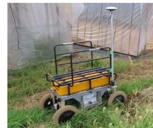
▲ 電動小型運搬ロボット
