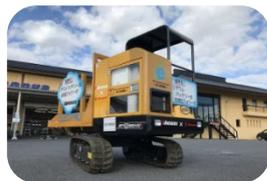
バッテリー式フォークダの試験開発機
