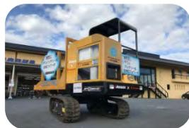
バッテリー式フォワードの試験開発機
