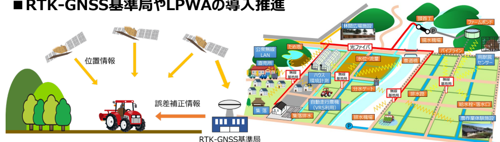
RTK-GNSS基準局の導入
