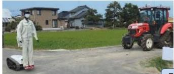
▲車両や周辺状況をPCやタブレットから遠隔監視 ▲センサーにより障害物(人)を認識し、緊急停止
