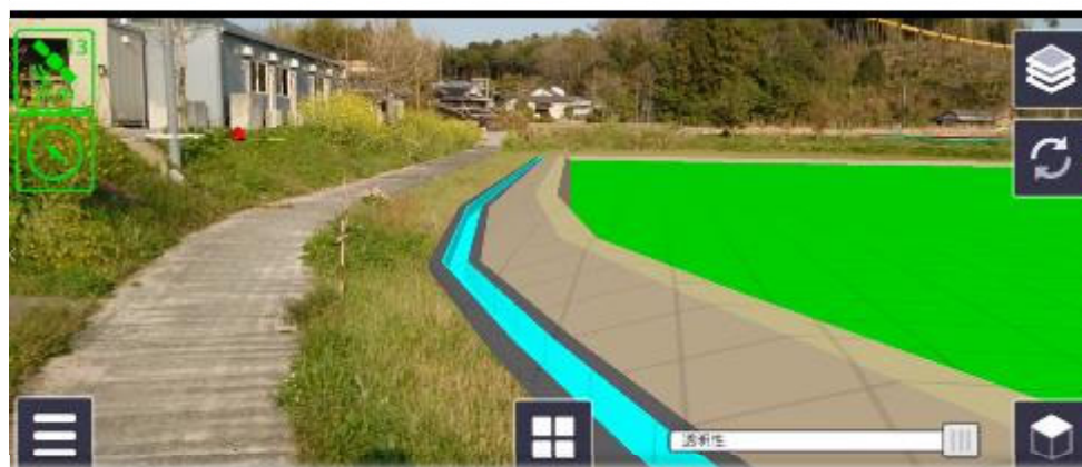
AR画像（工事後の水路位置等を表示）
