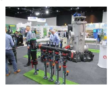
目詰まりによる破損や通水障害を防止するフィルター濾過装置
