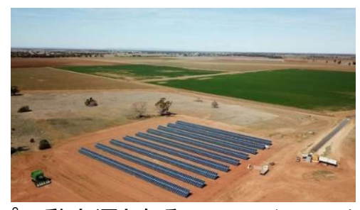
揚水ポンプの動力源となるソーラーシステム
