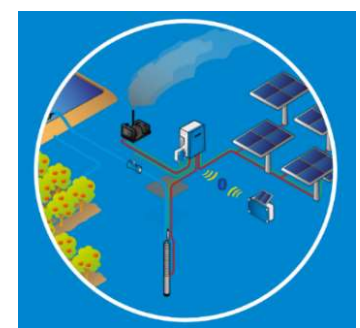
揚水ポンプの動力源となるソーラーシステム
