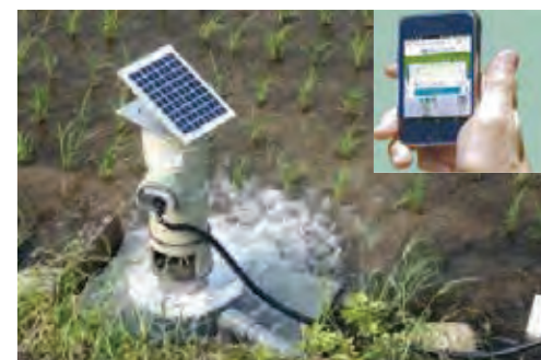
水管理を省力化するための自動給水栓の設置 （広い面積を耕作する担い手や、起伏がある 中山間地域の見回り回数削減に有効）
