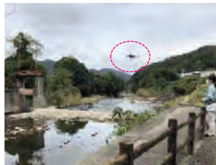
UAV (ドローン) による 頭首工の点検
