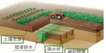
土壌改良 暗渠排水 疎水材 補助暗渠
