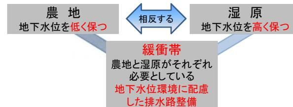
新設の排水路設置に当たり、湿原と隣接する農地に緩衝帯を設置し、湿原と農地の共生を図る。
