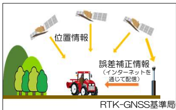
自動走行の精度を高めるRTK-GNSS基準局
