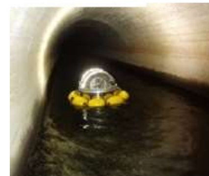
点検ロボットによる 通水中の水路トンネルの点検
