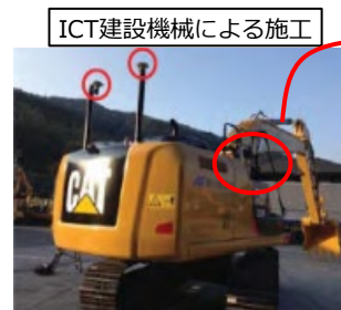
ICT建設機械による施工
