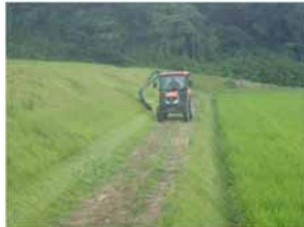
刈払い機による人力作業→トラクタ装着アーム式モア
