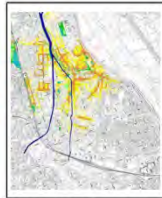
対策後の浸水想定図 (1/30確率)
