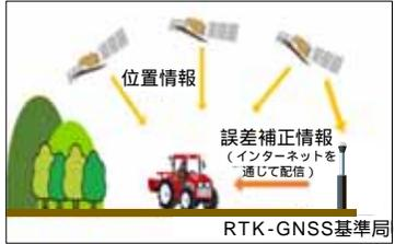
自動走行の精度を高めるRTK-GNSS基準局
