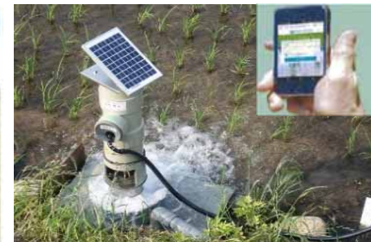
水管理を省力化するための自動給水栓の設置 （広い面積を耕作する担い手や、起伏がある 中山間地域の見回り回数削減に有効）
