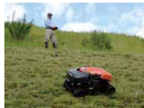
傾斜地の多い中山間地域におけるリモコ ン草刈機の導入（法面の緩傾斜化）
