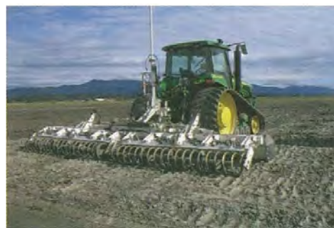
19 写真-5.3.1 運土量削減型整地工法による作業状況（左：表土と下層土の反転、右：運土・整地）
