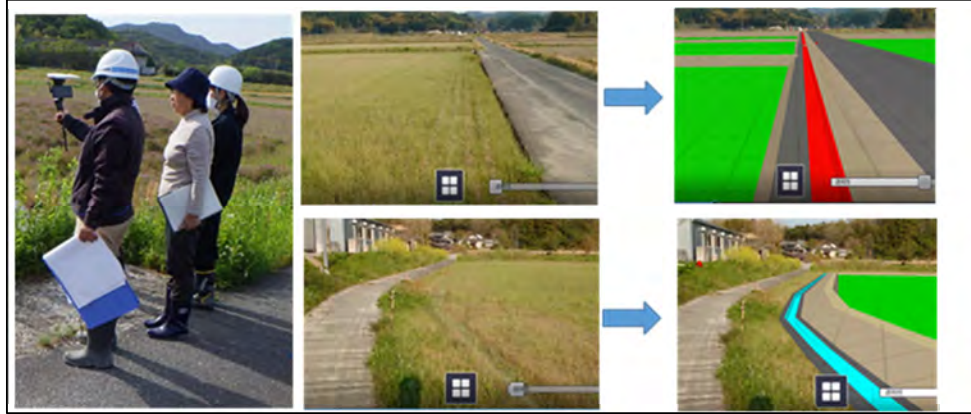
1 2 図-5.1.3 ほ場整備事業の概要説明に VR（仮想現実）（上）、AR（拡張現実）（下）を用いて活用する 3 BIM/CIM モデルの例 6)
