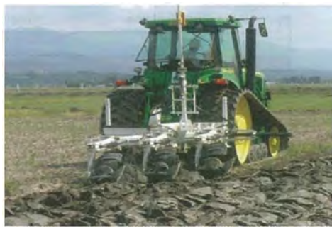
19 写真-5.3.1 運土量削減型整地工法による作業状況（左：表土と下層土の反転、右：運土・整地）
