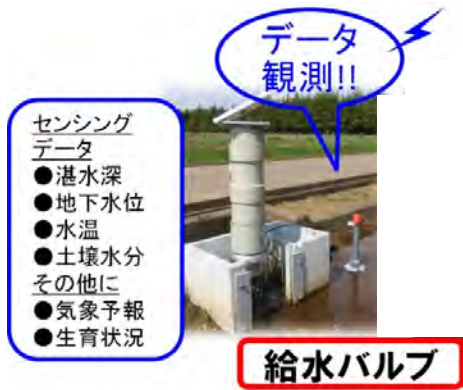
図-3.6.9 多機能型自動給水栓の例 7)
