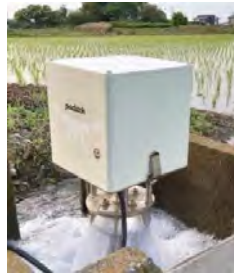
写真-3.11.1 水田水管理の自動化の事例 1)
