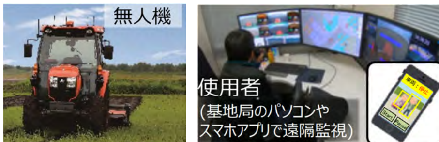
図-3.11.2 ローカル 5G を利用した遠隔監視による自動走行農機の導入事例 2)
