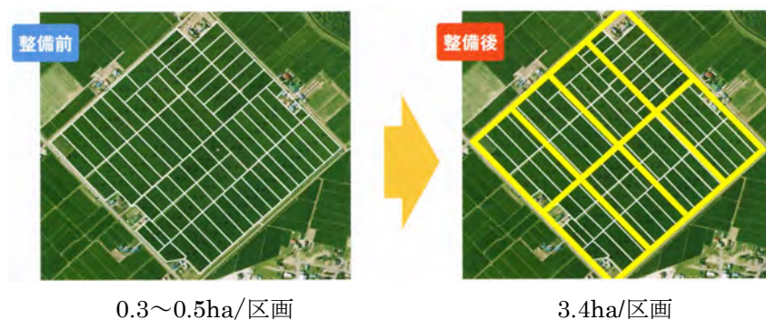
18 19 0.3~0.5ha/区画 3.4ha/区画 20 図-4.1.1 大規模再編整備前後の区画の変化（イメージ）
