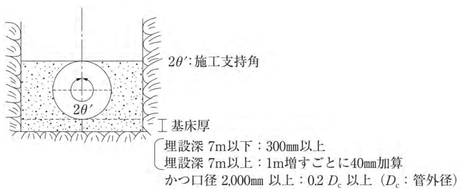
図-4.6.5 岩盤の場合の基礎工
