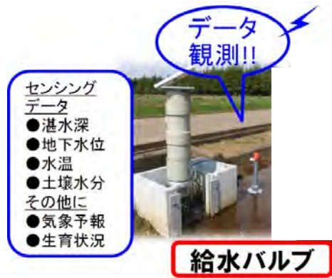
図-4.6.9 多機能型自動給水栓の例 7)
