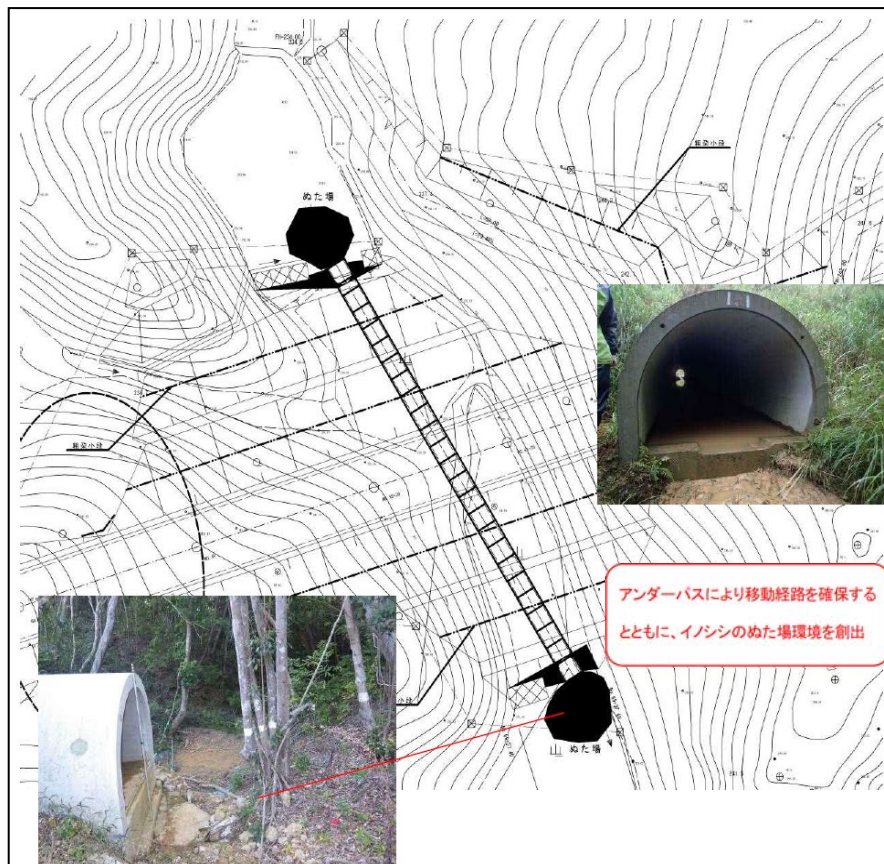
アンダーパスの設置
