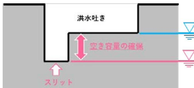
図-16.97 洪水吐きスリットイメージ図
