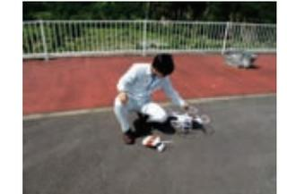
運航させる直前には、使用するUAV機体の状態について点検を行うことが重要であり、機体の外観に加え、ネジの締付状態、バッテリー状態、送信機の状態やカメラ、記録媒体の状態等の確認を行っている。このほか、UAV本体のマニュアル等に準じた確認も必要であるとともに、機体の航法用センサー等のキャリブレーション（イニシャライズ=初期化）を行っている。
