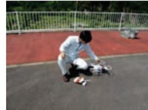
運航させる直前には、使用するUAV機体の状態について点検を行うことが重要であり、機体の外観に加え、ネジの締付状態、バッテリー状態、送信機の状態やカメラ、記録媒体の状態等の確認を行っている。このほか、UAV本体のマニュアル等に準じた確認も必要であるとともに、機体の航法用センサー等のキャリブレーション（イニシャライズ=初期化）を行っている。
