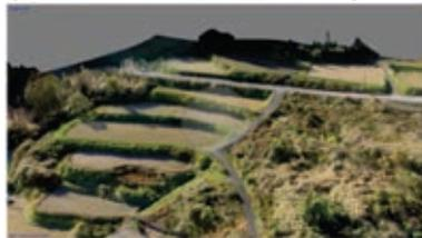
小型UAV空撮画像を基にSfMソフトウェアを用いて生成した三次元モデルからは、地形や地表面の傾斜や凹凸などの詳細な状況の把握が可能となるだけでなく、三次元-CAD（Computer-aided design:コンピュータによる設計支援ツール）などと組み合わせることにより、高度な景観シミュレーション画像の作成なども可能である。
