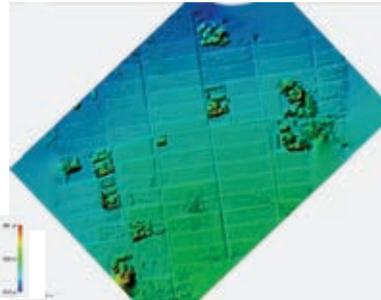
[成果2：三次元モデル（三次元空中写真）の生成例]
