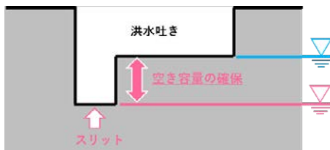
図-16.97 洪水吐きスリットイメージ図
