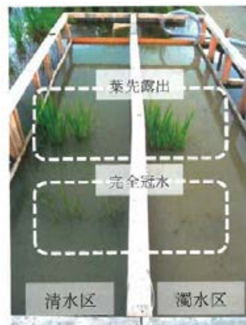
図-5.5 冠水試験中の様子 (手前が最深部)
