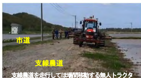
図-3.4.11 農業機械の接触事故防止を考慮した支線農道の整備事例
