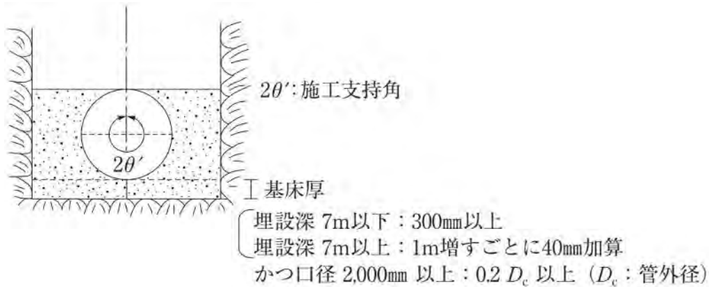
図-3.6.8 岩盤の場合の基礎工
