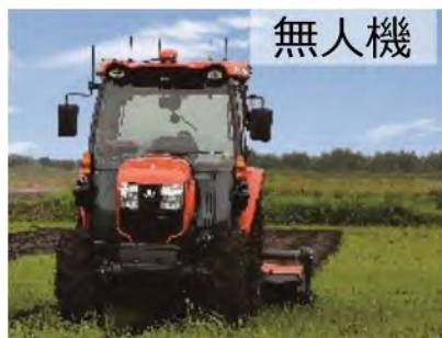
図-3.11.2 ローカル 5G を利用した遠隔監視による自動走行農機の導入事例 2)
