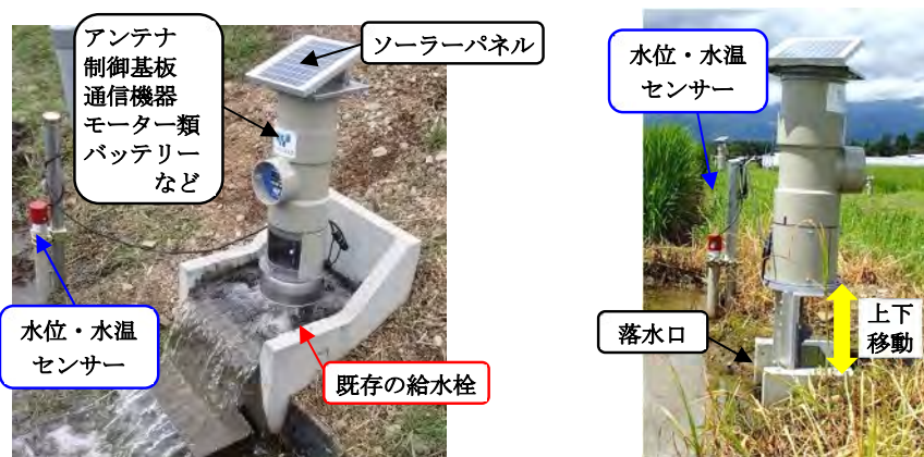
図-3.10.3 給水栓（左）及び落水口（右）に取付けたほ場水管理システムの制御装置
