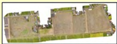
情報化施工で得られた3次元点群データ (ほ場及び周辺の工事完成形状)
