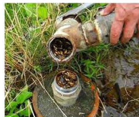
カワヒバリガイによる給水栓の目詰まり
