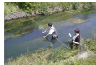
流速観測状況
