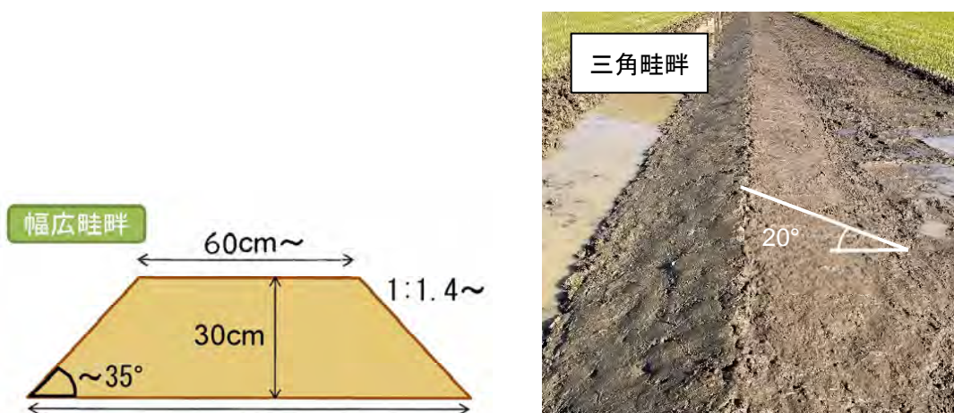
24 図-4.3.10 リモコン草刈機に対応した畦畔断面 4)
