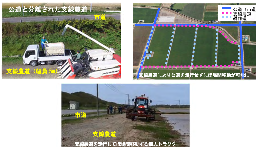
18 19 図-4.4.9 農業機械の接触事故防止を考慮した支線農道の整備事例 6)
